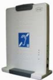
Переносная информационная система состоит из микрофона и передающей панели
